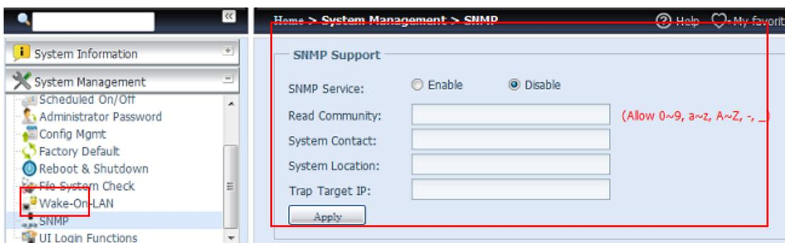
Dal menu, selezionare la voce **SNMP** per far apparire la schermata **SNMP Support** (Supporto SNMP). Da qui, è possibile selezionare **Enable** (Abilita) o **Disable** (Disabilita).
