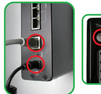
**DE** Verbinden sie nun die Kabel und schalten sie den N1200 ein
